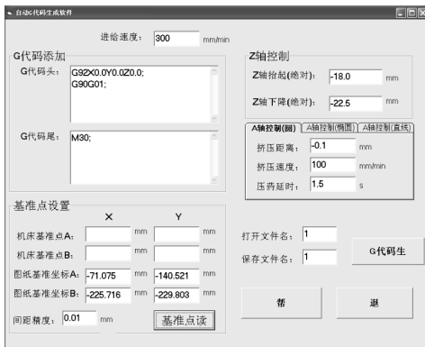
图 13 自动运行程序生成软件操作界面
