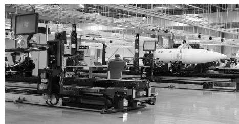
图 1 美国雷锡恩公司导弹自动化装配平台 [3]
