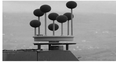
图 10 车载声学探测装置
