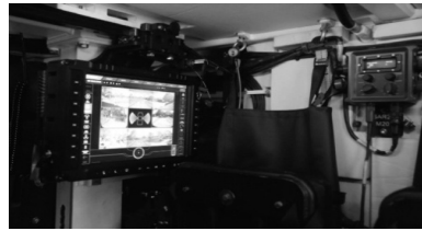
图 11 新加坡猎人步战车态势显示终端
