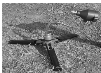
图 3 装配完整的小型聚能销毁装置
