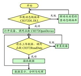
图 3 计算机端的软件流程图
