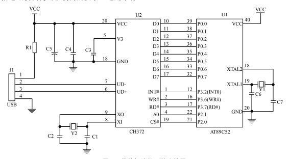
图 1 单片机端的硬件连接图
