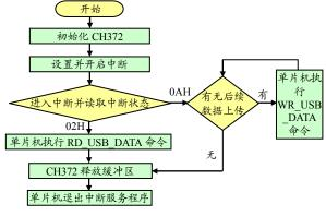
图 2 单片机端的软件流程图
