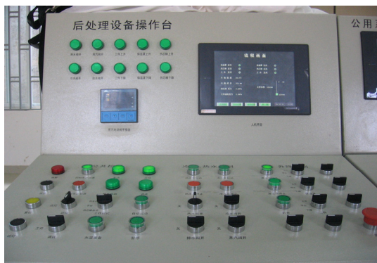
图 3 后处理设备远程控制界面
