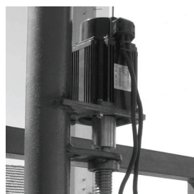
图 7 姿态靶架纵向移动机构
