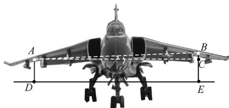
图 2 飞机滚转角测量示意图
