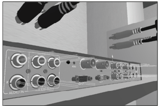
图 3 中兴 T502 音/视频接口碰撞体预设
