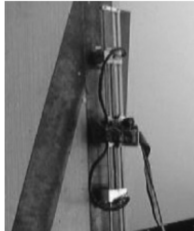
图 23 爬铁塔机器人 [40]
