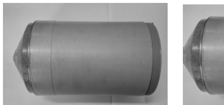
图 7 改进后粘接无缝隙, 解决了易分离、歪斜现象
