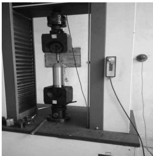
图 5 粘接强度试验
