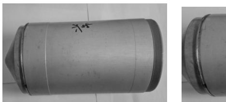
图 6 改进前粘接有缝隙, 易产生分离、歪斜现象
