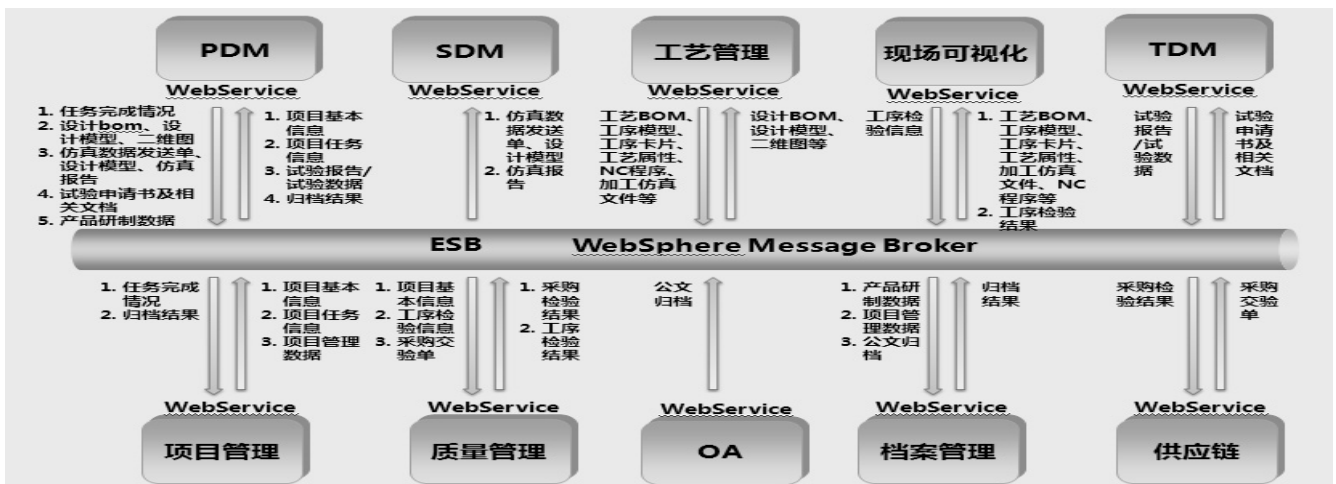
图 2 基于 ESB 的各数字化系统输入输出信息关系
