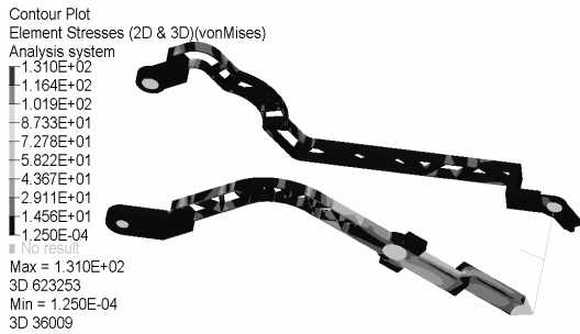
图 12 优化后左右两臂应力云图
