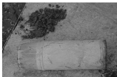
图 3 TKX-50 基混合炸药试验后试验弹状态
