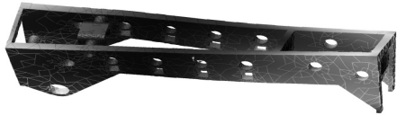
图 3 起落架扭转模态
