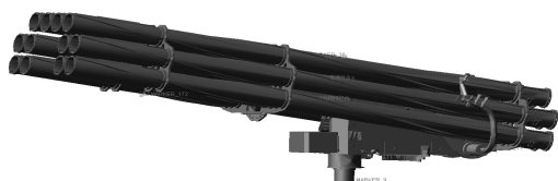
图 1 高低随动装置多刚体模型
