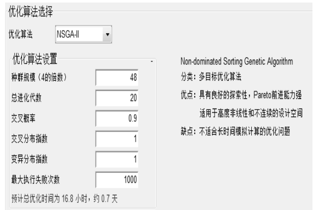
图 3 NSGA-II 进化计算参数设置界面
