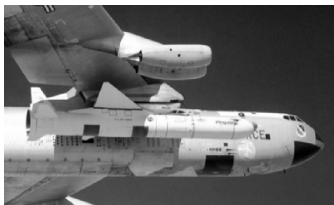
图 5 B-52 吊挂空射运载火箭
