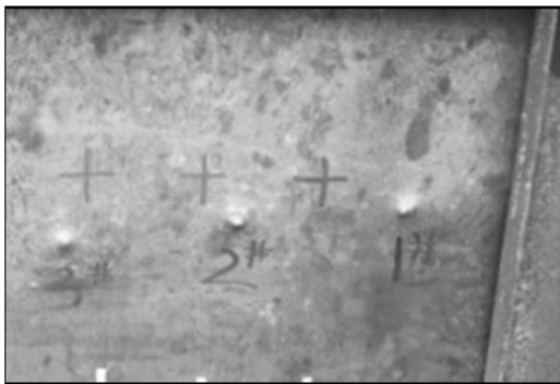
图 4 枪弹侵彻试验结果
