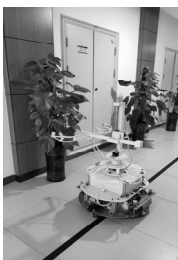
(c) 喷洒装置展开并喷洒作业
