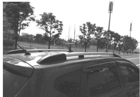
图 5 定位终端安装实景
