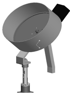
图 2 机械式弹壳自动排序花盘
