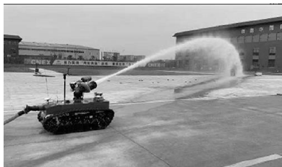
图 8 消防机器人灭火实验现场
