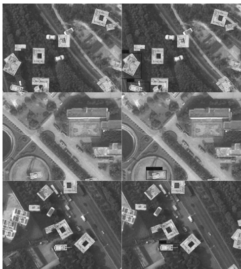
图 2 原始 RGB 图像与 YOLOv3 神经网络识别结果
