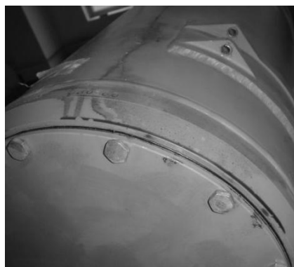
图 5 TNT 熔铸装药长期仓储渗油
