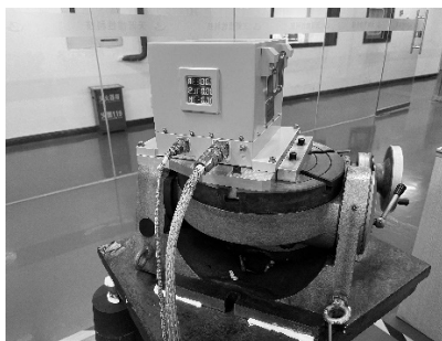
图 14 光纤陀螺寻北仪测试实验
