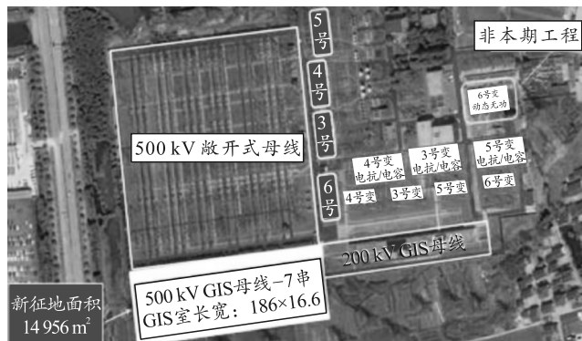
图3 改造后变电站场地布置
