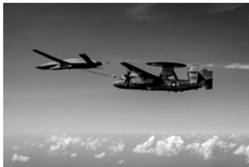
图 2 MQ-25A T1 对 E-2D 的空中加油测试
