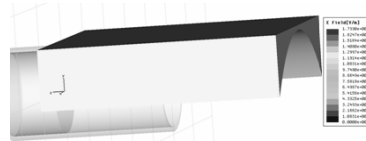
图 8 VLASOV 准光变换器的电场分布
