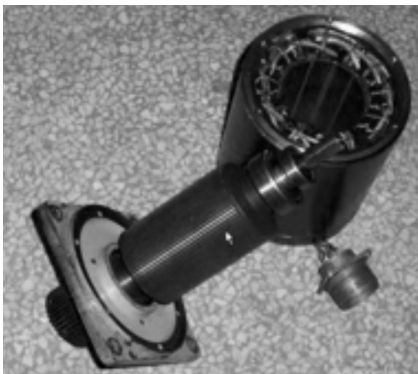
图 2 混合式步进电动机的典型结构
