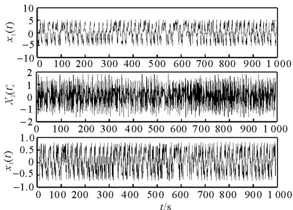
图 2 混沌鲁里叶系统的状态图
