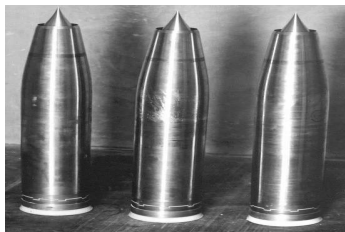
图 7 南非 155 mm 固体燃料冲压发动机增程炮弹
