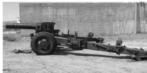
图1 火炮膛内燃烧与力学环境试验装置
