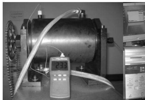
图3 发射装药动态活度试验装置
