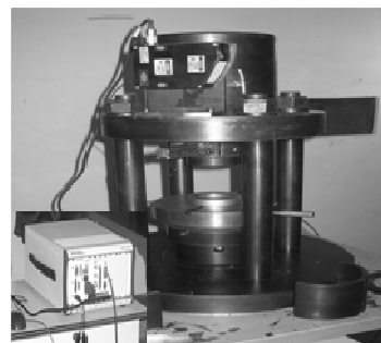
图2 发射装药动态挤压破碎试验系统
