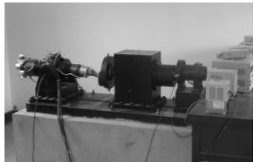
图 6 高速旋转弹丸三自由度角运动模拟装置
