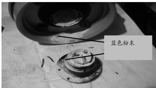
图 9 再现末制导炮弹外压发动机堵头漏气现象
