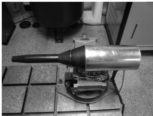
图 7 滚转控制装置照片
