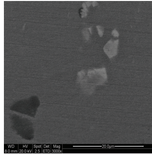
图 6 Al-Mg-Mn 合金 2 极化前的形貌
