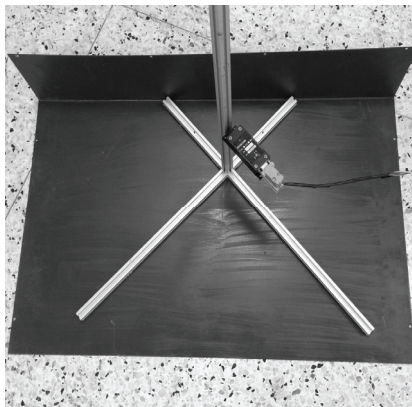
图 6 加入铁磁干扰物质 B 实物图
