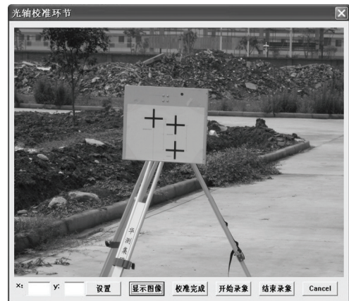
图3 光轴校准及图像采集软件界面
