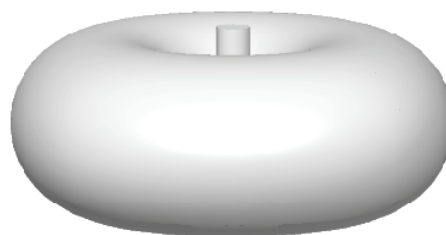
图 3 机载天线方向图仿真结果
